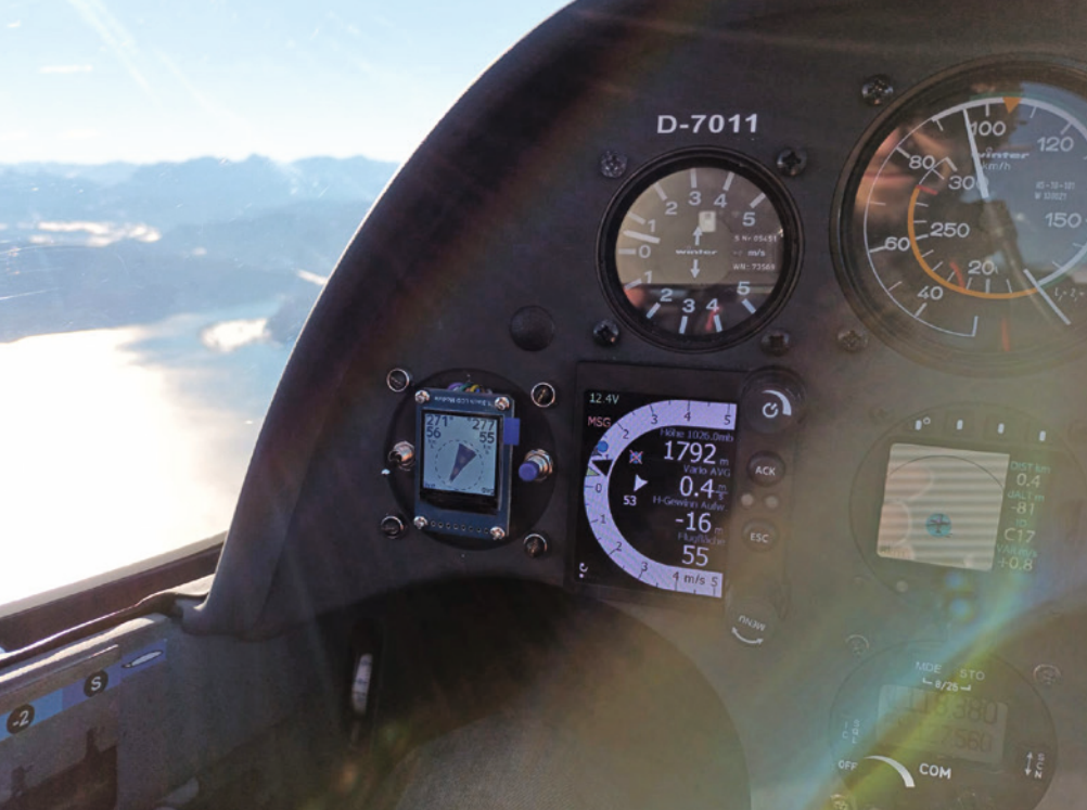
Zur ursprünglichen Entwicklung wurde der Prototyp (Display links) zur Verifizierung mit der Windmessung des AirGlide Variometers verglichen
