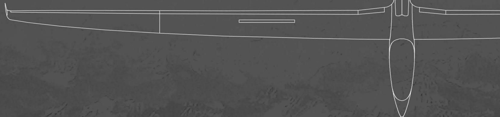
Basierend auf der Profildfamilie der AS 33, wurde der neue 20m Flügel der AS 35 Mi darauf ausgelegt hohe Flächenbelastungen von 44kg/m<sup>2</sup> - 62kg/m<sup>2</sup> zu ermöglichen.
