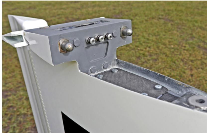
Bilder 5: pneumatische Anschlüsse für das Höhenruder
