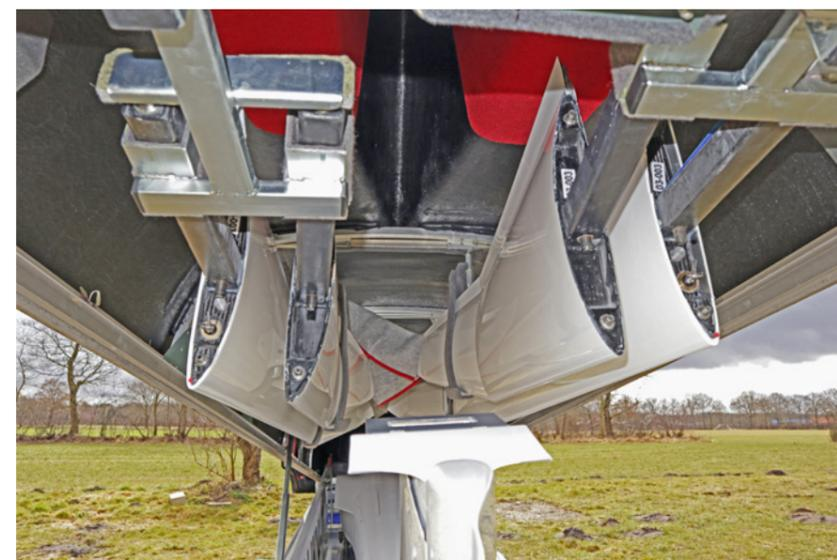
Bild 1: Das ausgefahrene Jettriebwerk bietet kaum Widerstand
