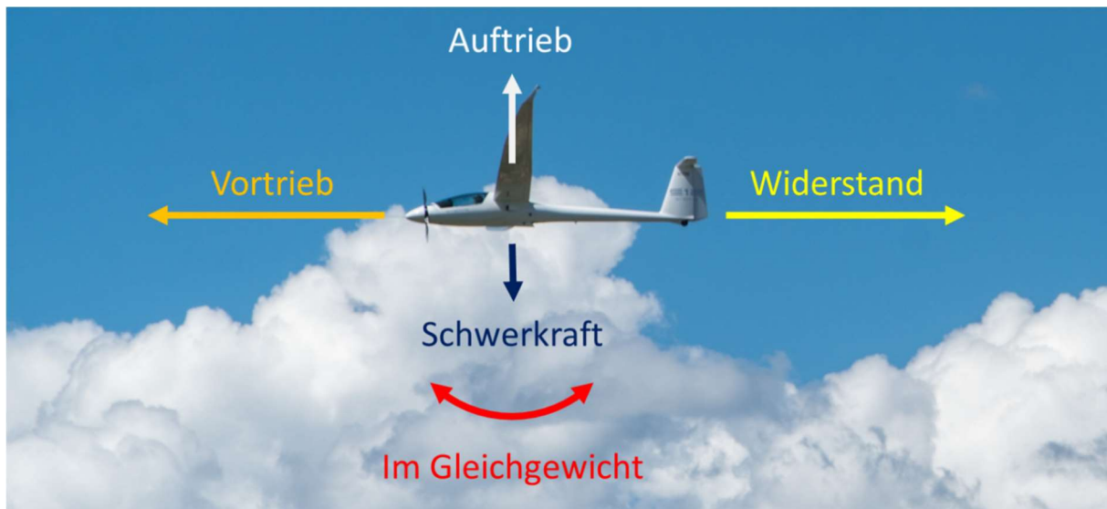
Kräfte diagramm am Beispiel einer S12 im Motorflug
