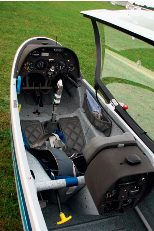
*Piloten bis zu 2,06 m Körpergröße passen in das vordere Cockpit. Die Mindestzuladung beträgt 55 kg*
