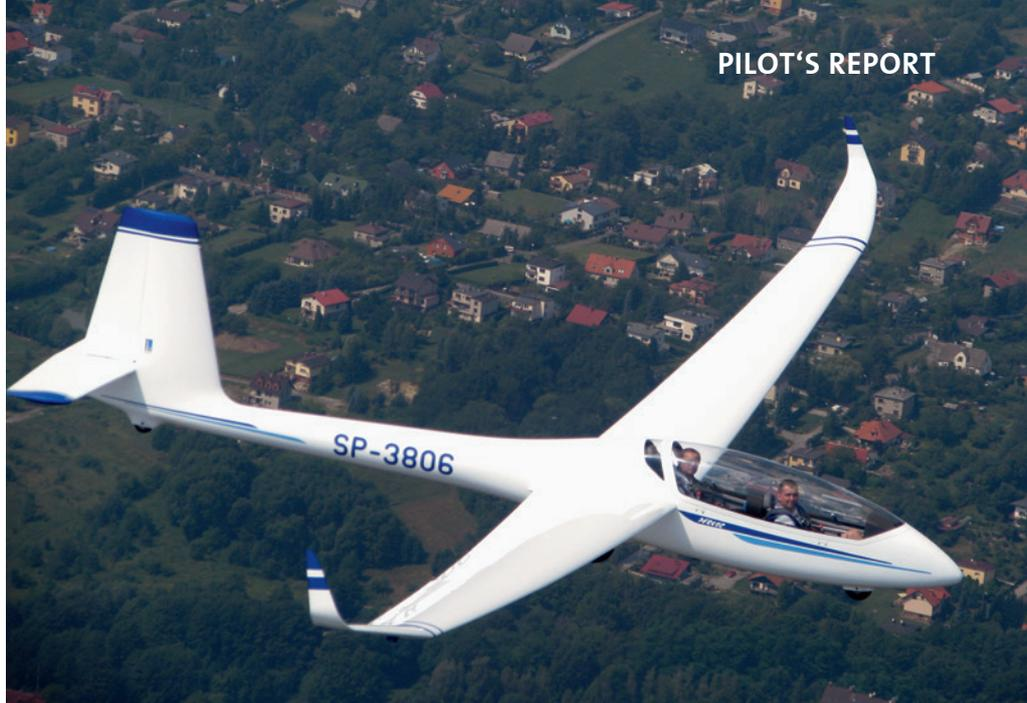
*Mit 20 m Spannweite und Winglets ist der Perkoz für Schulung und Streckenflug geeignet*
