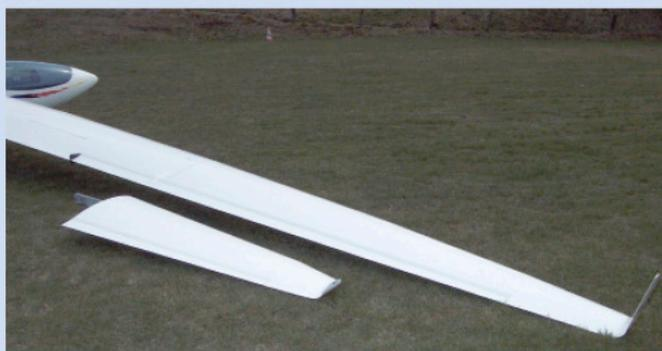
aus abgedichteten Kästen nach oben aus. Neben der Standardklasse mit ungeteilten 15-Meter-Flächen wurde ab 2003 die von Michael Greiner entwickelte ASW 28-18 angeboten, deren Spannweite durch 2,25 Meter kurze Außenflächen aber auch auf 15 Meter für den Einsatz in der Standardklasse reduziert werden konnte. Die aufgesetzten Winglets passen auch auf die langen Außenflügel.
