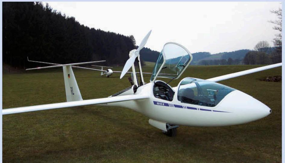
*Die zweiteilige Haube von der ASK 21 und der filigrane Propellermast des Wankelmotor-Modells*
