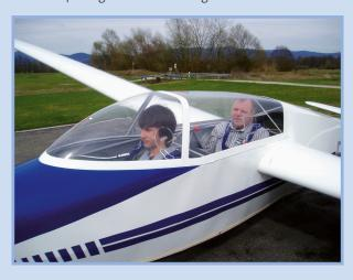
Seitenruderpedalen. Die Trimmung erfolgt über eine Flettner-Klappe. Die Windenkupplung sitzt auf der linken Seite und die Bugkupplung sollte man mit einem Tennisball an der Gummischnur schließen, da es sonst im Cockpit recht zieht. Im F-Schlepp hinter einer Remo steigt der Flieger mit etwa 100 km/h am besten, schnelleres Schleppen erhöht nur die Hebelkräfte und bringt kaum Zeitgewinn.
