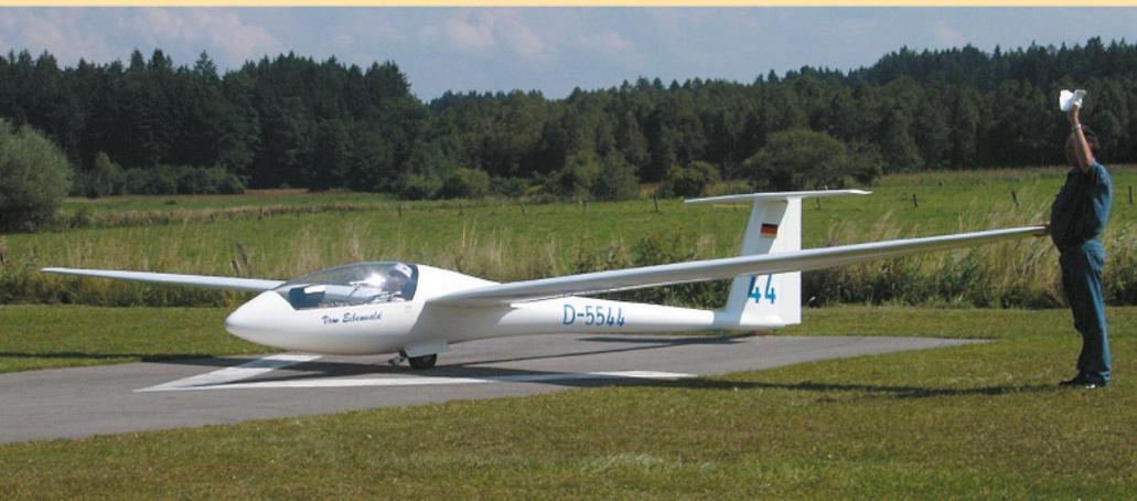
F-Schlepp ist sowohl an der Bugkupplung als auch an der am Fahrwerk angebrachten Schwerpunktkupplung möglich. Mit Wasserballast sind mindestens 120 km/h Schleppgeschwindigkeit gefordert.
