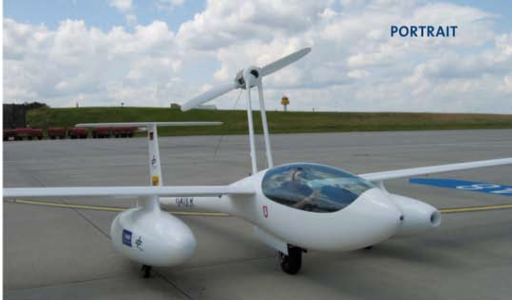
Antares DLR-H2: links der POD mit dem Wasserstoff-Drucktank, rechts der POD mit dem Brennstoffzellensystem – erkennbar am kleinen Lufteinlauf im Bug
