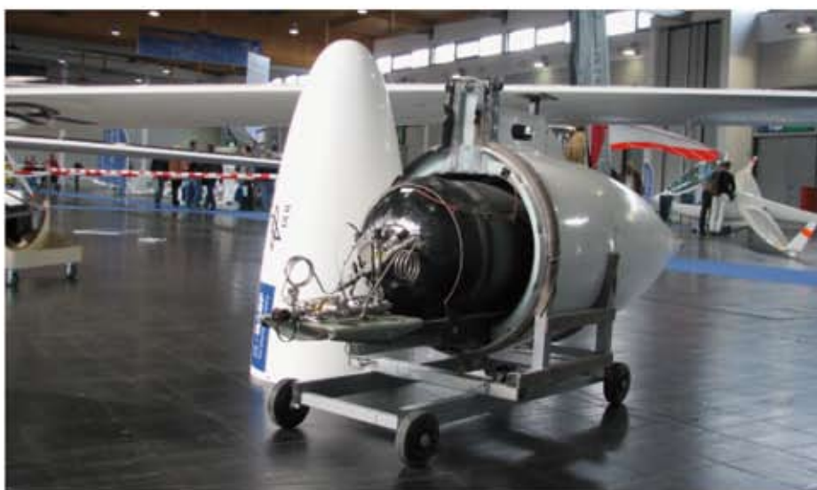
Das Innere des PODs mit dem Wasserstoff-Drucktank
